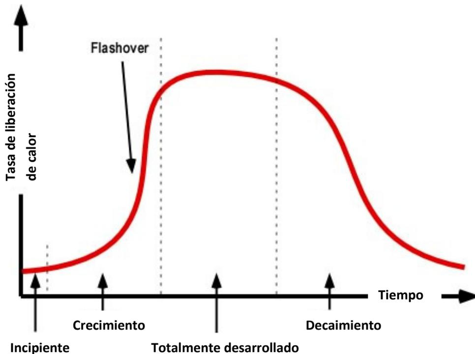
*Nota: la curva ilustra la tasa de liberación de calor. La forma de esta curva variará considerablemente según el tipo de combustible involucrado y el patrón de ventilación de la estructura. Aunque la temperatura generalmente sigue a la liberación de calor, la forma de la curva tiempo/temperatura puede ser diferente.*
