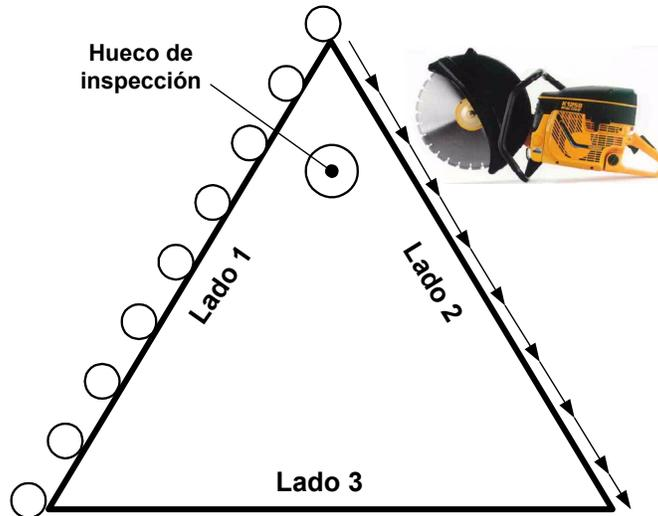
1. Comenzar con la perforación de huecos de debilitamiento utilizando el taladro en el Lado 1 del triángulo. Los huecos se hacen con una separación de 5 cms.
