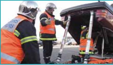
El espacio se ha creado utilizando el cilindro de separación. Los puntales deberán ser ajustados continuamente para asegurar que provean una estabilización óptima.
