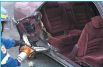
Coloque las puntas del separador entre el corte de alivio realizado en la base del poste B. Abra el separador para empujar el panel hacia afuera creando una tercera puerta.
