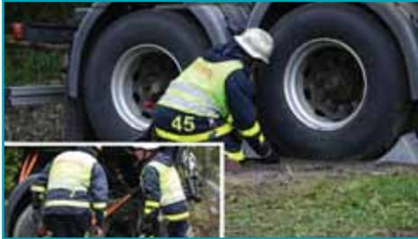
Realice un bloqueo de las ruedas y de la cabina; puede ser necesario amarrar la cabina al chasis si el mecanismo de bloqueo se ha dañado durante el impacto.
