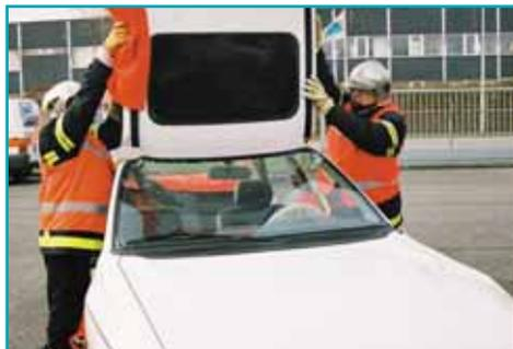
Ahora los rescatadores podrán doblar el techo hacia delante. Puede ser necesario utilizar una barra o una estructura rígida para ayudar en el proceso de doblado.
