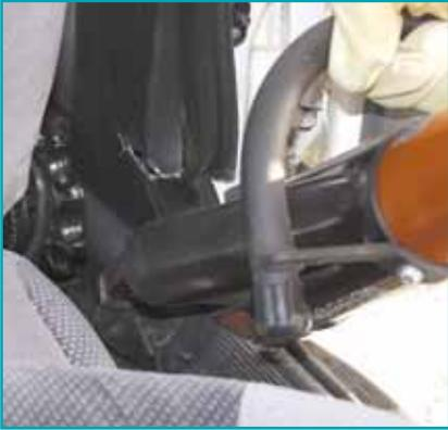
Con la puerta posterior abierta haga un corte de alivio profundo en la parte más baja del poste B con el fin de debilitarlo.
