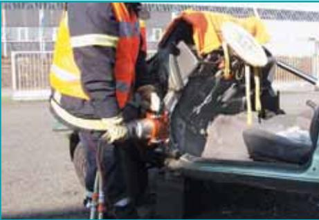
Si es posible colocar un cilindro al otro lado del vehículo, esto le facilitará este proceso ; levante lentamente el tablero, vigilando continuamente los puntos de contacto del separador y el vehículo.
