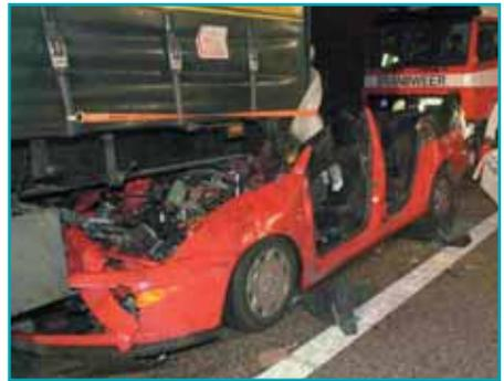
Las actividades de rescate pueden afectar a la estabilización. Por esta razón, la estabilización debe ser continuamente revisada según se vaya avanzando en el proceso de extracción. Los sistemas de soporte pueden complementar los esfuerzos de estabilización.
