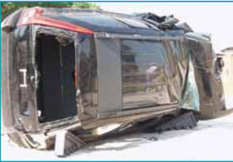
Asegúrese que el vehículo no se va a girar, colocando los soportes debajo de los postes A y C.
