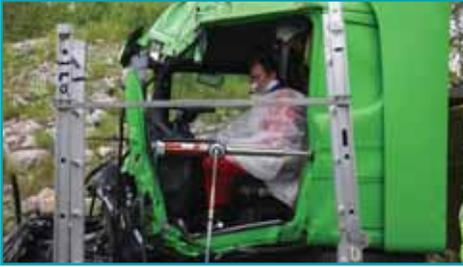
Realice una separación hacia delante del tablero en forma controlada, solamente hasta retirar a la víctima atrapada.
