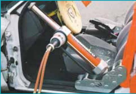
Coloque el cilindro y asegúrese de que está en su sitio realizando una pequeña cantidad de presión. Esto evitará que el tablero ceda cuando se realice el corte de alivio. Asegúrese que la posición del mando de operación se encuentre hacia fuera y no hacia arriba.
