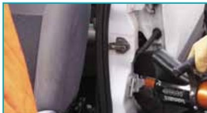
Retire la puerta trasera cortando o separando las bisagras expuestas.
