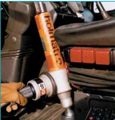
En muchos casos es altamente beneficioso inclinar o empujar la columna de la dirección hacia arriba. Esto puede ser realizado usando el propio sistema de doblez de la columna del vehículo o si se requiere, empujándola hacia fuera con nuestras herramientas.
