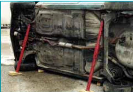
Cuando se utilizan puntales mecánicos puede ser necesario colocar cuñas en sus bases para asegurarlas y que no se deslicen.
