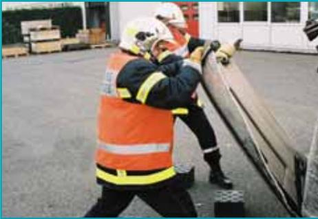
Para crear una plataforma horizontal de trabajo coloque bloques de apuntalamiento donde va a colocarse el techo cuando se doble. Doble el techo hacia abajo tan suavemente como sea posible para evitar desestabilizar el vehículo.
