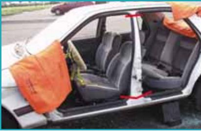
Corte las partes superior e inferior del poste B y retírelo. Recuerde colocar una protección contra los bordes cortantes que se generaron.
