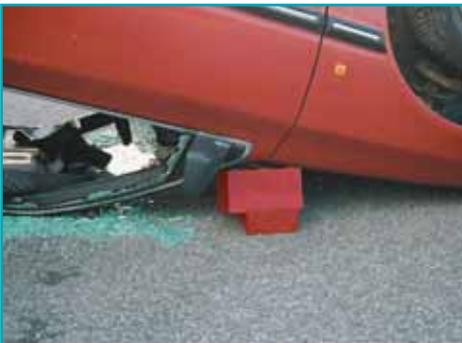
Agregue bloques adicionales al espacio comprendido entre el compartimento del motor y el parabrisas para garantizar una estabilización adicional.
