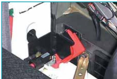
*Sistema automático de desconexión*
