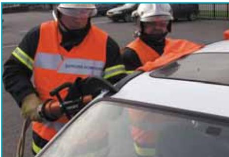
Después de asegurarse de que existe una protección adecuada del cristal, realice un corte de alivio en ambos lados del techo, justamente detrás del parabrisas.
