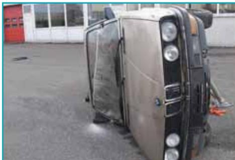
Corte el parabrisas en un ángulo tal y como se muestra en la foto para crear un punto amplio de bisagra.
