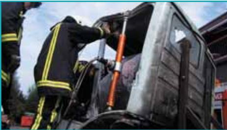
Si se requiere, puede empujar el techo hacia arriba, haciendo un corte de alivio en ambos lados y empujando con un cilindro.
