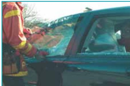
Cualquier ocupante del vehículo deberá ser protegido antes de romper los cristales. Puede ser necesario tener un rescatador en el interior del vehículo para ayudar con esta protección.
