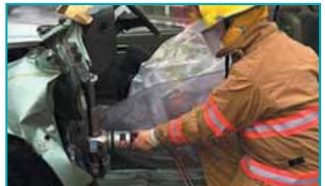
Levantamiento del tablero con un cilindro
