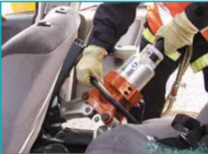
Coloque una de las puntas del separador en la base de los asientos traseros. Abra el separador lentamente mientras observa la estabilidad del punto de apoyo y la posición de la otra punta en la parte baja del poste B. Ahora separe el poste hacia fuera rompiéndolo desde su base.
