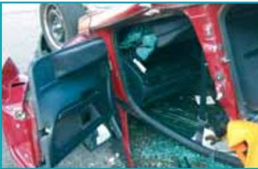
Una vez que la puerta esté abierta y después de reventar el pasador de la cerradura, proceda a cortar o separar las bisagras y retire toda la puerta.
