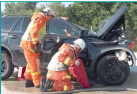
Cuando utilice bloques escalonados una cuña puede ser usada para garantizar que el bloque quede asegurado. También si se usa invertido el bloque escalonado actúa como una gran cuña y funciona bien.
