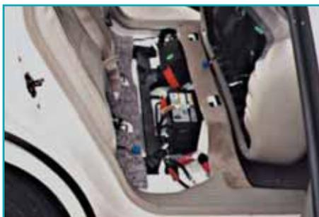
Algunos fabricantes pueden usar un mecanismo que desconecta la batería automáticamente en el caso de una colisión.
