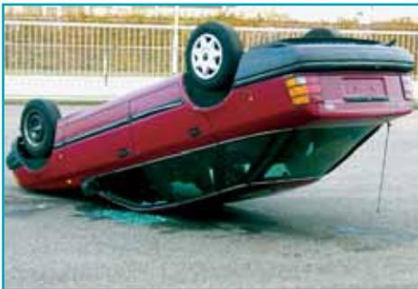
Estabilice el vehículo utilizando bloques, tal como se mencionó anteriormente. Recuerde que el vehículo mostrado en éste ejercicio tiene el peso del motor en la parte delantera. Otros vehículos con el motor en la parte trasera, requerirán ser tratados de otra forma diferente.
