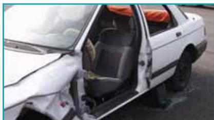
Primero retire la puerta delantera usando una de las técnicas mostradas anteriormente.
