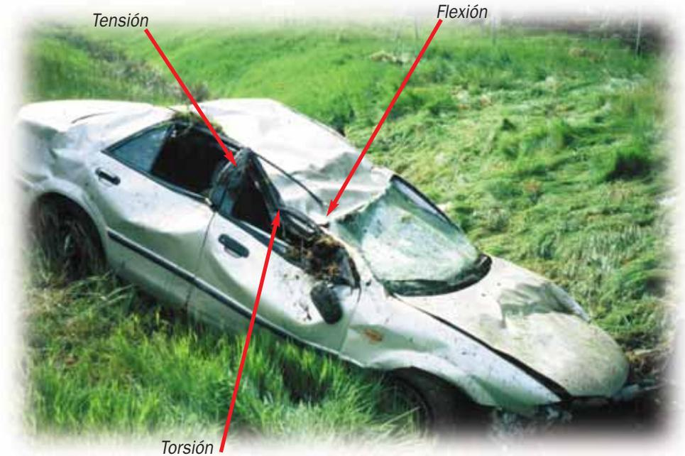
Cuando mencionamos la reacción mecánica (el impacto durante la colisión que modifica la estructura del automóvil) queremos decir puntos estables y de puntos inestables o elásticos.
