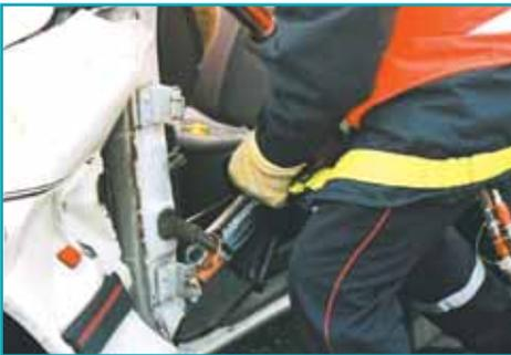
Realice un corte de alivio en la base del poste A. Cuando el espacio es limitado, puede ser necesario realizar éste corte antes de colocar el cilindro.
