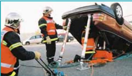
Debe emplearse un sistema de ataque combinado a lo largo del proceso de corte, elevación y estabilización.
