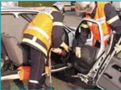
Retire la puerta delantera cortando las bisagras, mientras los otros rescatadores sostienen las puertas.
