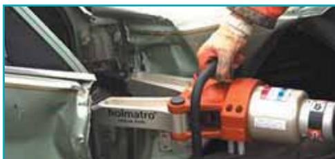
Haciendo uso de un punto estable de separación, por encima de la parte alta de la bisagra, la puerta puede ser ahora retirada fuera del vehículo.
