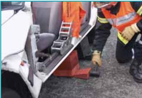
Establezca el vehículo como se ha mencionado anteriormente. Agregue una estabilización adicional directamente debajo del poste B donde la base del cilindro esté colocada. Aunque no todas las situaciones permitirán su utilización, el uso de un soporte de cilindro es altamente recomendado para distribuir la fuerza ejercida en la base.
