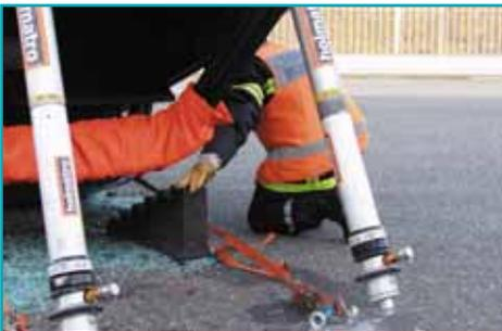
Si Usted pretende doblar el techo hacia abajo, retire los bloques de la parte de abajo del techo. Si no, continúe con ellos en su sitio.
