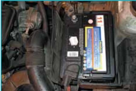
El sistema de encendido del vehículo deberá ser colocado en la posición "off" (apagado) y la batería deberá ser desconectada. Es importante que el terminal negativo sea desconectado primero con el fin de evitar la posibilidad de generación de chispas causadas por colocar a tierra el terminal positivo en forma inadvertida.
