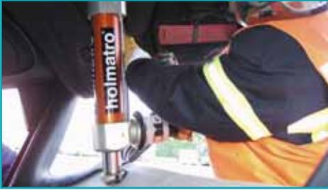
Coloque un cilindro de elevación en un punto de soporte estable del techo y colóquelo bajo presión entre el techo y el suelo del vehículo.
