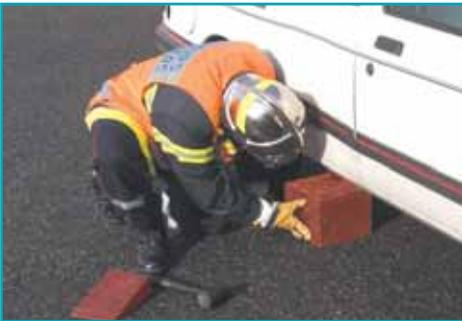
Los bloques de estabilización deberán ser colocados en su sitio con la suficiente presión sobre el vehículo para que se garantice que queden bien colocados y soportando el automóvil.
