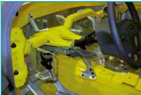
*Barra de acero al boro en el tablero que puede afectar las técnicas usadas para separarlo.*
