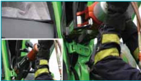
Retirar la puerta empleando las técnicas para intervenir las bisagras cuando sea posible. Comenzando por ellos normalmente se descubre que la puerta es fácilmente retirada tras cortar o romper las bisagras.
