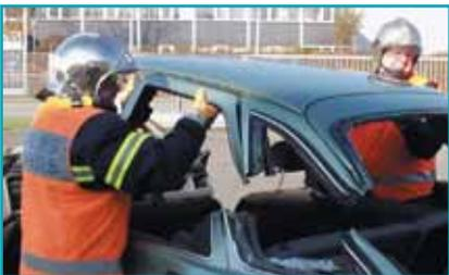
Ahora los rescatadores pueden levantar el techo y llevarlo hacia el área designada para colocar las partes cortadas.
