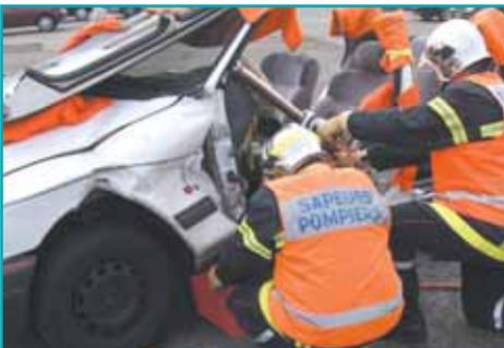
En este momento se puede empezar la extensión del cilindro. Asegúrese de vigilar ambos puntos de apoyo durante esta operación. Recuerde revisar la estabilización durante todo el procedimiento, realizando cualquier ajuste requerido. Utilice bloques en forma de cuñas en la apertura del corte de alivio.
