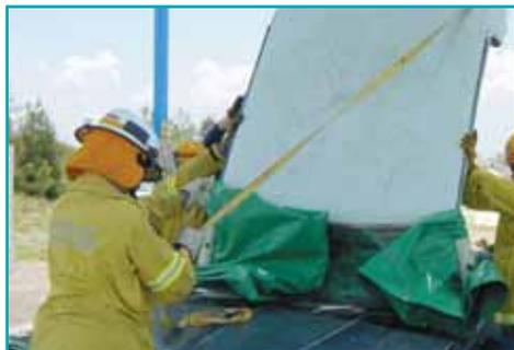
Se deberá utilizar una cinta para asegurar el techo en la posición de doblado.
