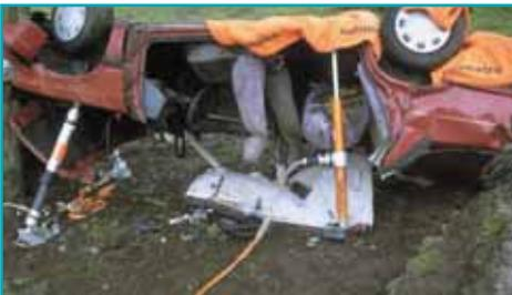
Las técnicas de creación de espacios pueden ser usadas de diferentes modos para crear una amplia zona de trabajo o para permitir la extracción de víctimas atrapadas.
