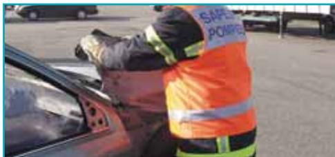
El tablero ahora puede ser retirado con ayuda del separador. Tenga cuidado mientras separa el panel ya que puede soltarse repentinamente de la carrocería.
