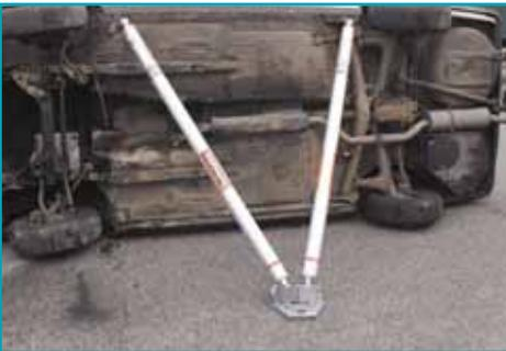
Realice un apuntalamiento lateral con puntales mecánicos (madera, metal), hidráulicos o neumáticos.
