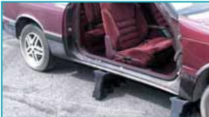
Retire primero la puerta delantera utilizando una de las técnicas mencionadas anteriormente.
