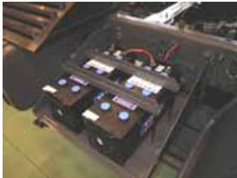
**Sistema eléctrico:** Poseen unos grandes compartimientos de bancos de baterías que pueden estar conectadas entre sí para suministrar 12 ó 24 Voltios, siendo el más común el sistema de 24 voltios con 2 baterías de 12 voltios cada una conectadas en serie. Pueden existir dos compartimientos para las baterías en dos sitios diferentes.
