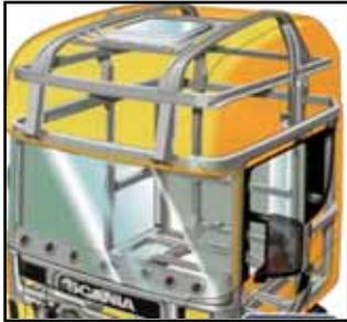
**Techo:** Generalmente es de un material liviano como fibra de vidrio o metal. Poseen dos o más refuerzos en acero que van desde adelante hasta atrás. Puede estar cubierto con un gran alerón de fibra de vidrio y en el techo se pueden encontrar las bocinas de aire y la unidad de aire acondicionado.
