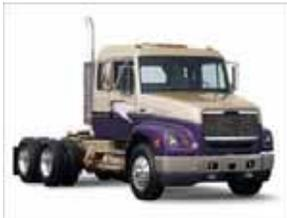
**Cabina convencional:** En este tipo de cabinas el asiento del conductor esta localizado detrás del motor del vehículo, la cabina no tiene sistema de bisagra para inclinarse, la parte frontal es normalmente fabricada en fibra de vidrio, aunque algunas veces son partes en acero y aluminio las que cubren los postes y tienen un refuerzo del techo que es de acero.
