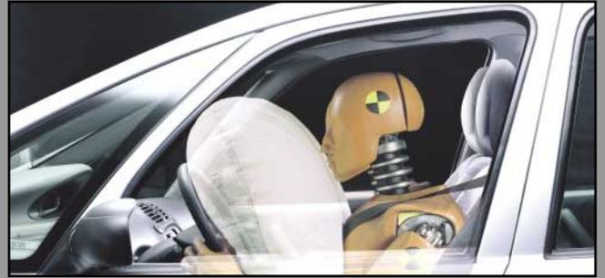
Esto se debe a que se pueden presentar distintos casos: 1) puede no activarse ningún componente; 2) pueden activarse sólo los pretensores del cinturón de seguridad; 3) pueden activarse los pretensores del cinturón y los airbags.
