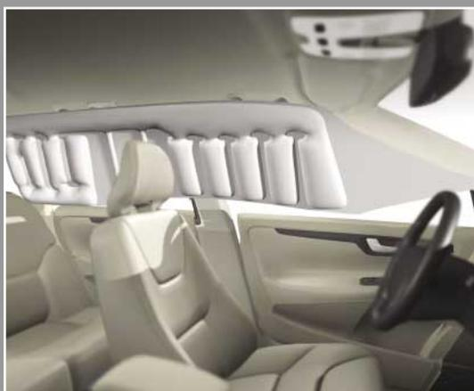
La activación del SRS se produce cuando existe una brusca desaceleración, y no depende únicamente de la velocidad al momento del impacto, ni de las deformaciones que se observan en el vehículo luego de producido éste.
