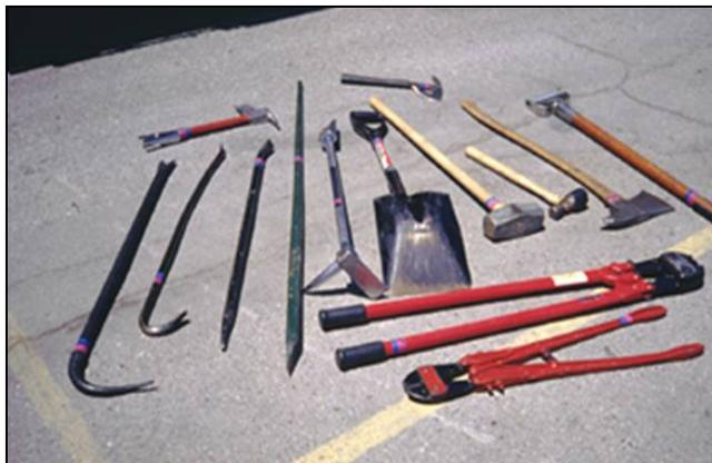
**Figura 9.4.3 (b):** Herramientas para Palanquear.
