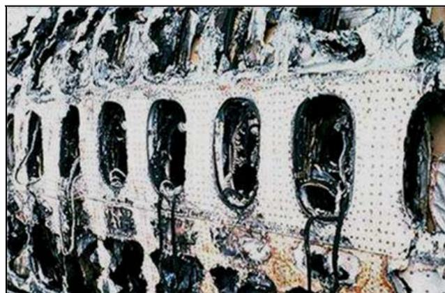
**Figura 8.2.2:** Recubrimiento de la Aeronave formado por láminas de Aluminio .
