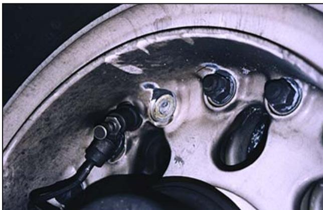
**Figura 8.1.4.:** Tapón Fusible de la llanta del Tren de aterrizaje.
