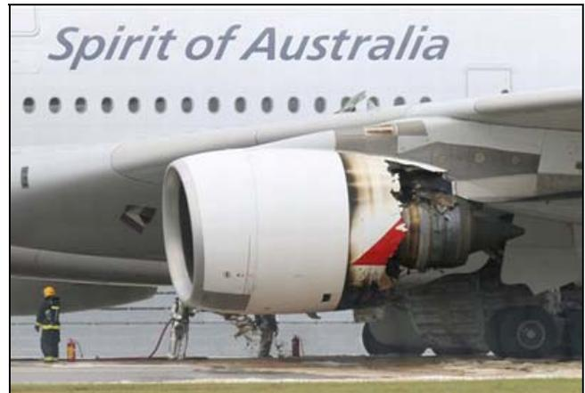
**Figura 12.2.3:** Incendio de motor confinado en la cubierta de motor.
