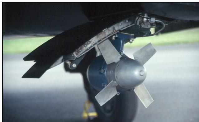
**Figura 7.5.8:** Turbina de Corriente de Aire.
