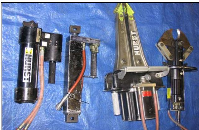
**Figura 9.4.3(d):** Herramientas Hidráulica de Rescate (desde La izquierda: elevador o expansor (largo), expansor cortador, y elevador o expansor (corto)).
