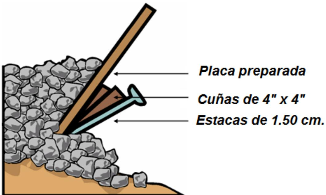
Para dar firmeza a las placas, se deben instalar estacas de a lo menos 1 1/2 mt. de altura, la placa se presionará con cuñas para dar firmeza, se debe colocar la placa en ángulo aproximado de 60°, contrario a los deslizamientos, se debe instalar una estaca a lo menos, es recomendable instalar dos estacas para evitar problemas de estabilidad.
