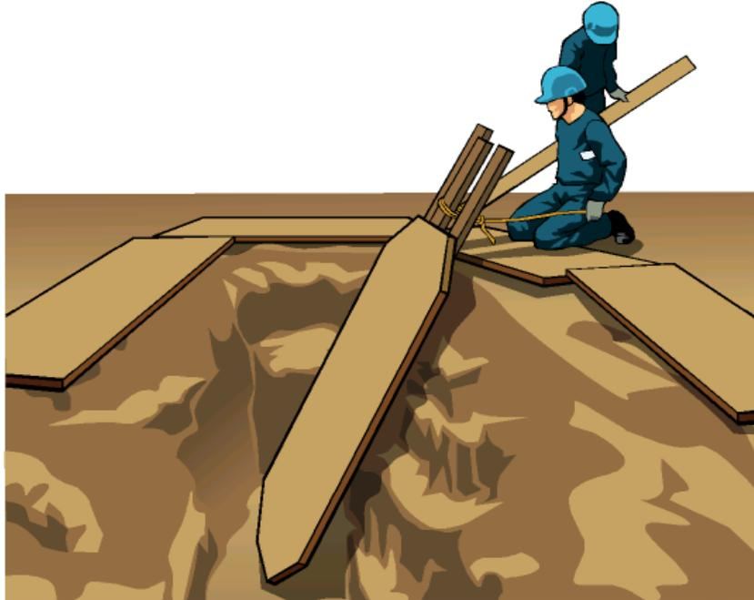
Se instala por el lado más seguro de la zanja, es por donde se trabajará todo el tiempo que dure el rescate. Para colocarla, gírelo hasta la posición vertical con el poste hacia el centro de la zanja y bájelo apoyado en maderos que sirven riel, luego ayúdese con un madero y deje esta placa apoyada en la pared contraria.
